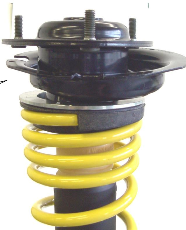
Das Serienmäßige Stützlager wird wie im Bild auf das Federbein aufgesetzt und mittels der mitgelieferten Stoppmutter verschraubt. Das Anzugsdrehmoment beträgt 35Nm. Fahrzeugspezifische Informationen zum Einbau des Federbeines in das Fahrzeug entnehmen Sie bitte den Unterlagen des Fahrzeugherstellers.
