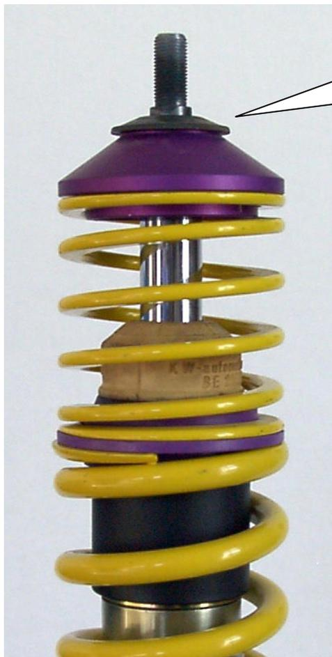
Angeliefertes Federbein mit der serienmäßigen Stützscheibe, welche zwischen Federteller und Stützlager montiert wird.
