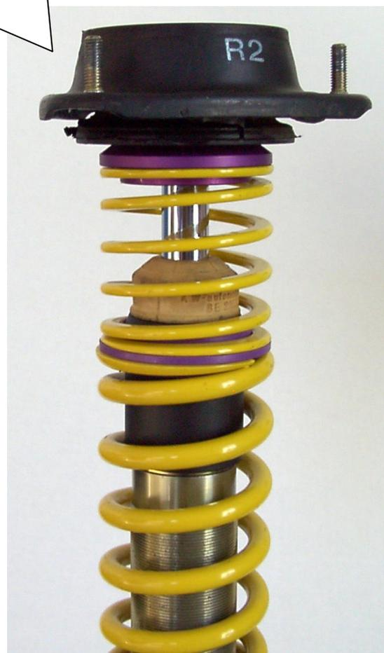
Nach erfolgtem Einbau des Fahrwerkes, ist die Freigängigkeit der Bereifung zum VA Federbein zu überprüfen. Das Mindestabstandsmaß an der engsten Stelle darf **5 mm** nicht unterschreiten und ist gegebenenfalls mittels handelsüblicher, TÜV geprüfter Distanzscheiben wieder herzustellen.
